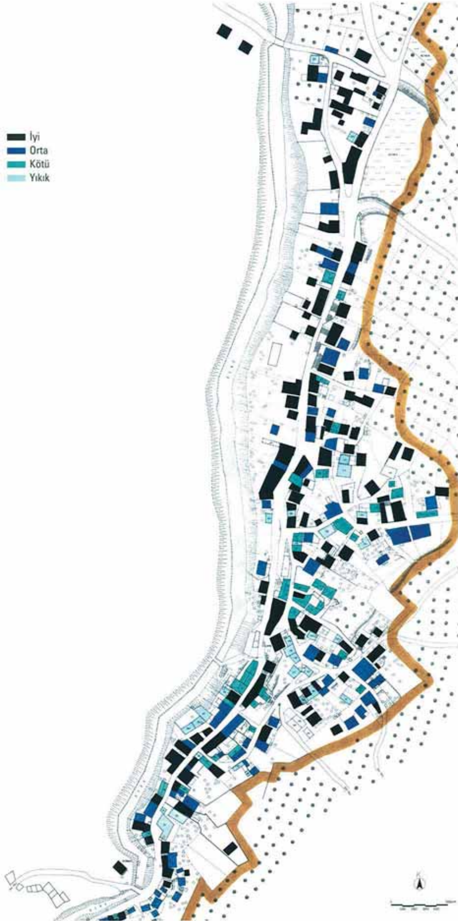
Şek. 11. Karsak köyündeki yapıların sağlamlık durumu analizi.
