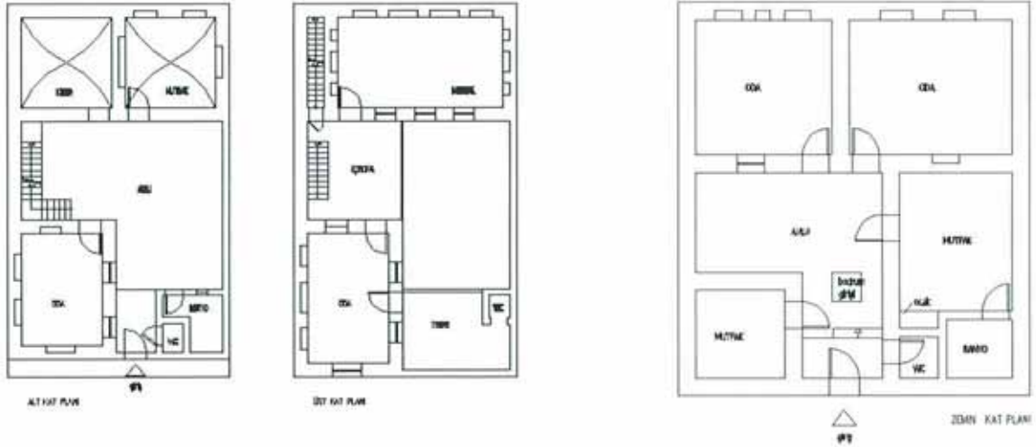
Şek. 4. Mekânların avlunun iki yanında gruplandıđı avlulu plan tipine örnek; Birecik, Meydan Mahallesi, 3 ada, 21 parselde bulunan konut (env. no: N39B0558).
